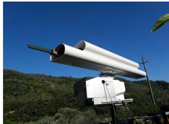
Fig. 1 - Prototipi di radar armonico entomologico sviluppati dal Politecnico di Torino nell'ambito del progetto LIFE STOPVESPA, per il tracciamento del volo di *V. velutina* e l'individuazione dei nidi.
