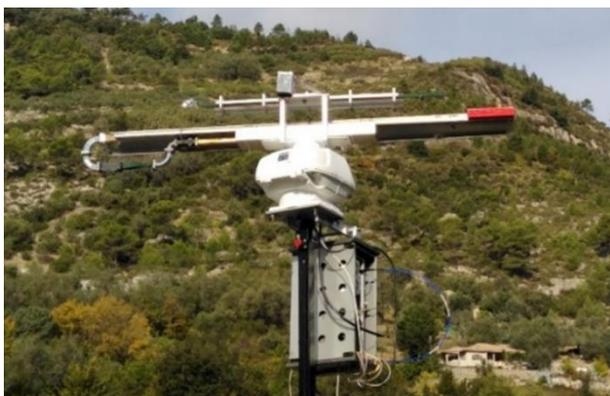
Figura 14 - Primo dei due prototipi di radar armonico entomologico sviluppati dal progetto LIFE STOPVESPA
