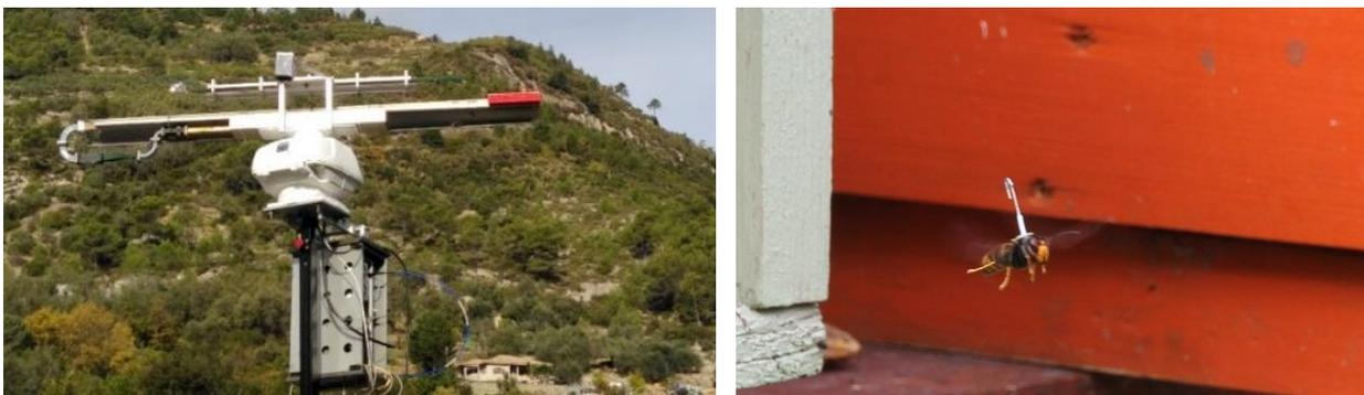
Figura 6 - Radar armonico per il tracciamento del volo dei calabroni sviluppato dal progetto LIFE STOPVESPA (sinistra) e esemplare di *V. velutina* dotato di tag (destra).
